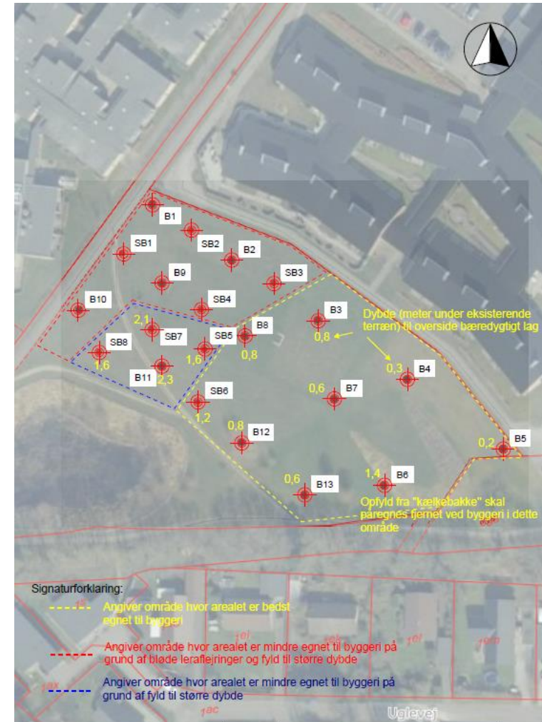
Geoteknisk kort med angivelse af egnet byggefelt
